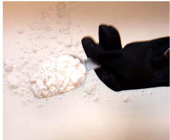
Filterpulver auf das Filterpapier auftragen.
