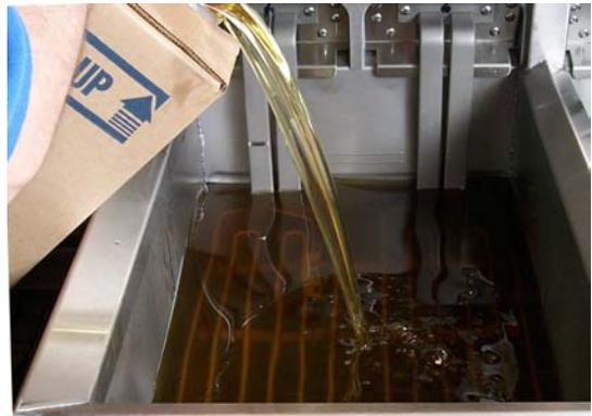
Solange Öl nachfüllen, bis es die obere ÖLFÜLLSTANDSLINIE erreicht. DIE FRITIERWANNE NICHT ÜBERFÜLLEN.
