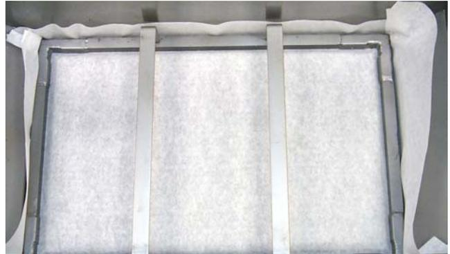
Filterpapier sitzt korrekt unter Niederhalterung. Beachten, dass das Filterpapier an allen Seiten über den Niederhalterung hinaussteht.
