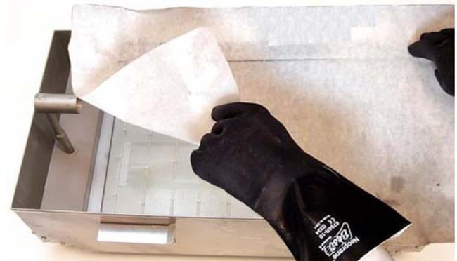
Filterpapier oben auf Filterwanne aufsetzen und Papier mit Niederhalterung sichern.
