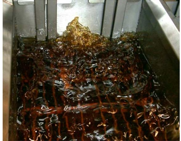
Öl 10 bis 15 Sekunden lang sprudeln lassen, um sicherzustellen, dass das gesamte Öl aus den Rückleitungen entfernt wurde.
