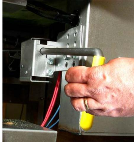
Ölrücklaufventil durch Ziehen am gelben Griff öffnen und Filterpumpe aktivieren.
