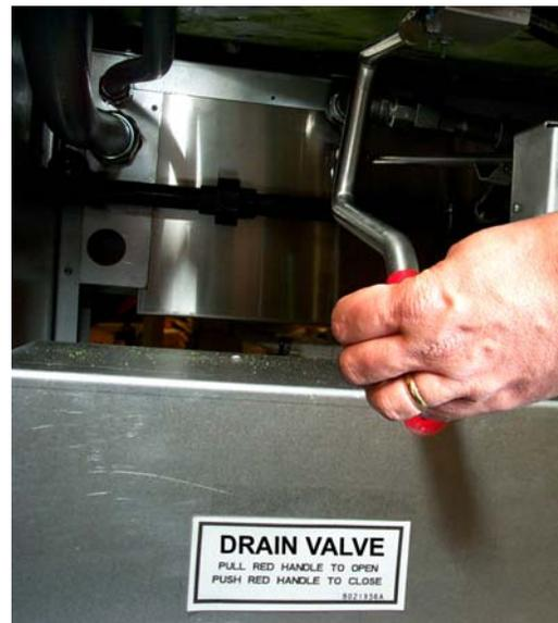
Ablassventil durch Ziehen am roten Griff öffnen.
