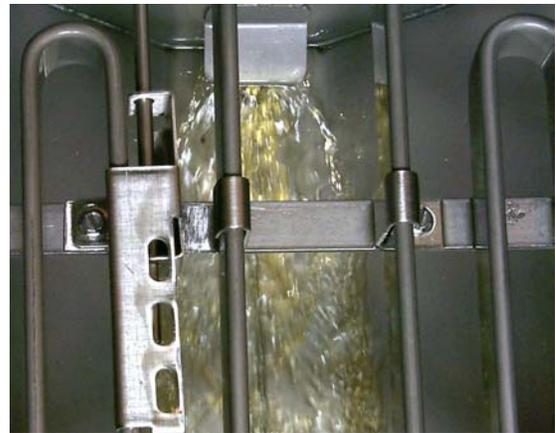
Öl 5 Minuten lang umlaufen lassen, damit alle Ablagerungen und Teilchen in Schwebelohaltung entfernt werden.
